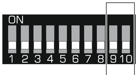
Rys. 2. Przełączniki służące do określenia trybu pracy kontrolera.
